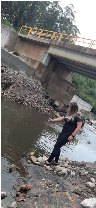
Figura 9 - Coleta de amostra para análise de sólidos em suspensão com o amostrador DH-48. Fonte: Ecossis, 2021.
