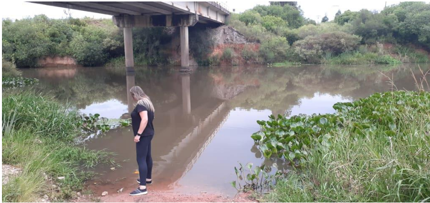
Figura 5 – Coleta de amostra para análise de sólidos em suspensão com o amostrador DH-48. Fonte: Ecossis, 2021.
